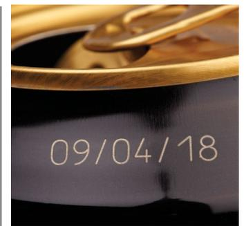
**Rimozione del colore su metallo per data di scadenza**
